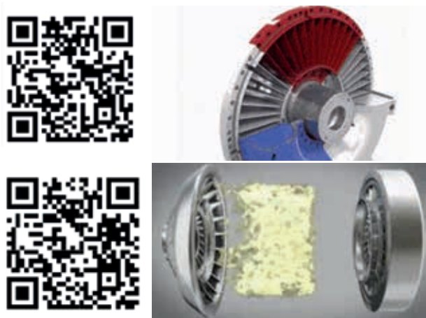
Рис. 6.7. Анімація роботи гідромуфти
