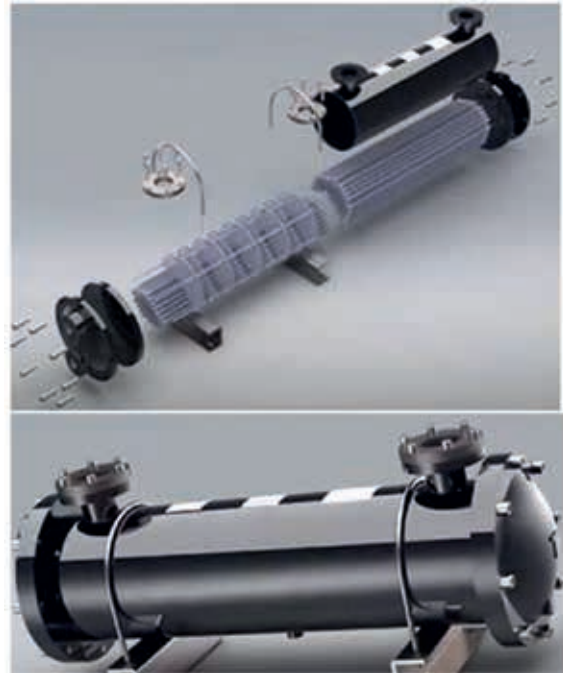
Рис. 5.10. Загальний вигляд і будова водяного охолоджувача
