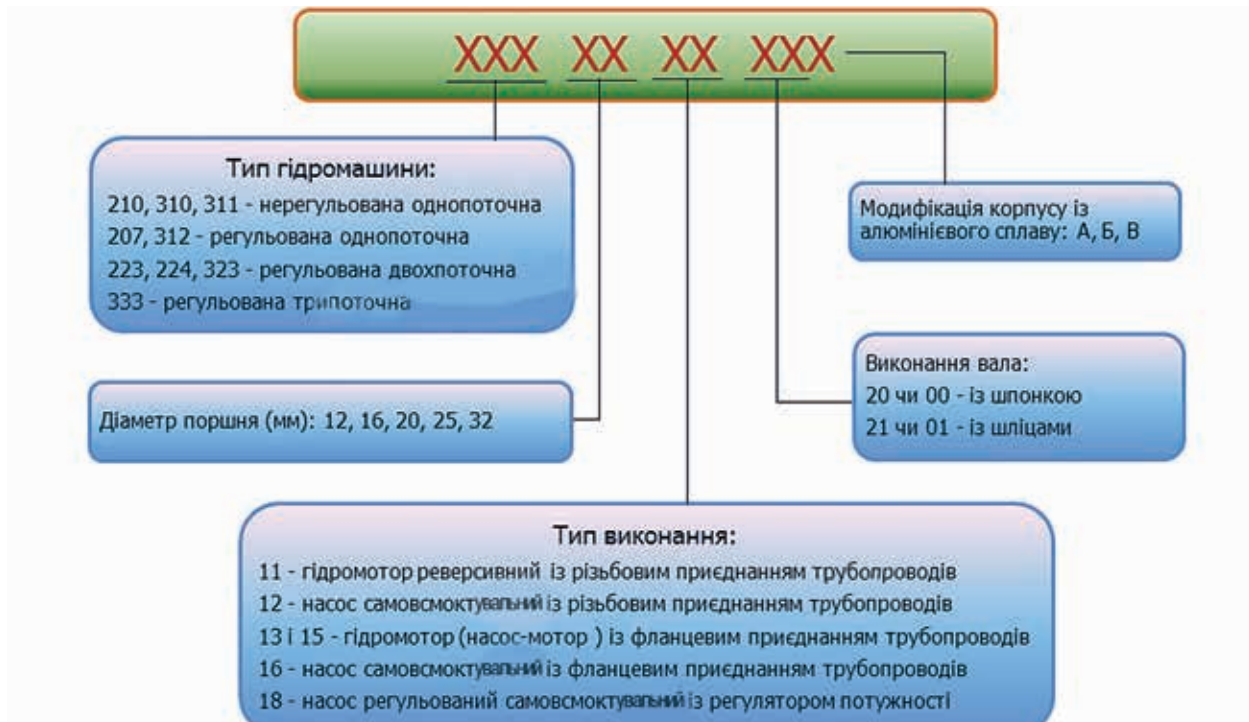
Рис. 3.17.1 Структура умовного позначення аксіальнопоршневих гідромашин серій 200 і 300
