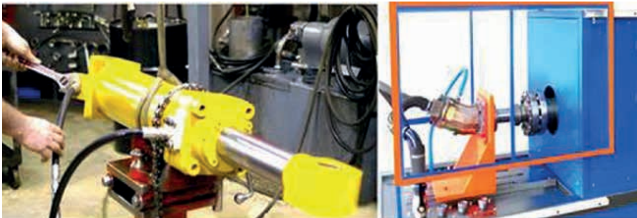
Рис. 8.8. Перевірка знятого з машин гідроциліндра та аксіально-поршневого гідродвигуна
