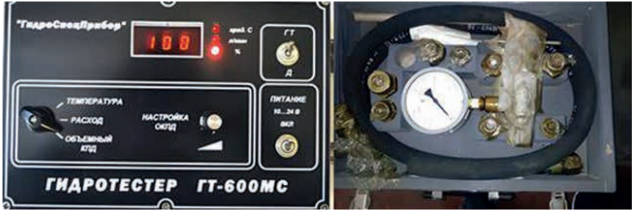
Рис. 8.7. Сучасний електронний гідротестер і прилад КІ-5473
