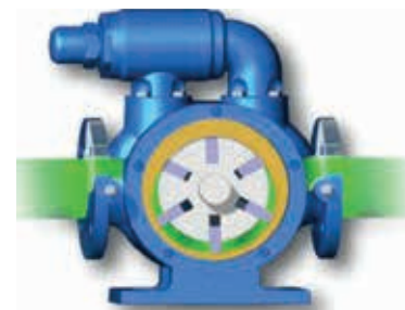
Рис. 3.42. Будова і анімація роботи пластинчастого насоса одноходової дії
