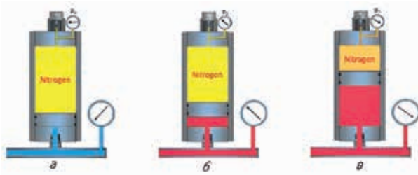
Рис. 5.21. Загальний вигляд і будова поршневого акумулятора
