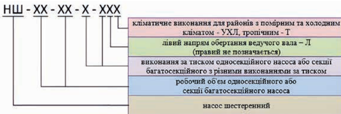
Рис. 3.29. Структура умовного позначення шестеренних насосів
