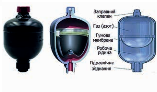
Рис. 5.25. Загальний вигляд і будова мембранного акумулятора
